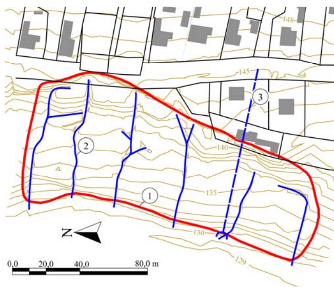
Obr. 9. Povrchové a podpovrchové odvodnenie územia. Vysvetlivky: 1 – teleso zosuvu; 2 – kopané povrchové rigoly; 3 – subhorizontálny odvodňovací vrt.
