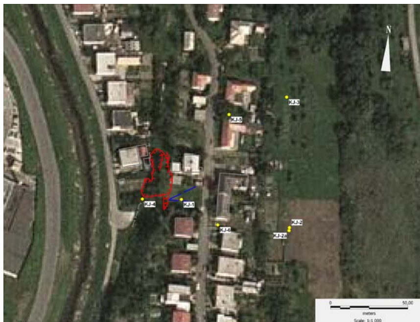
Obr. 1. Lokalizácia aktívneho zosuvu Krupina-Nad kotlom (červená línia) s vyznačením realizovaných vrtných prác (žlté body) a povrchových drenážnych rebier (modré línie) vybudovaných v decembri 2010 Ozbrojenými silami SR.
